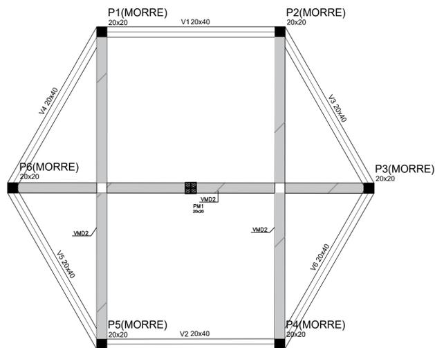
Forma do pavimento Fundação escala 1:50
